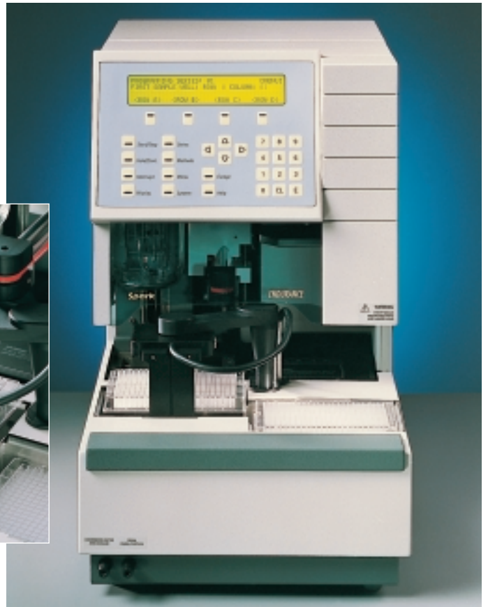
Titerplatte und x-, y-, z-Bewegung des Probenschlittens
