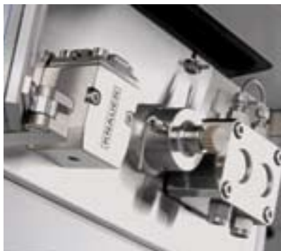
Pumpe P-1 mit Mischer und Pumpenkopf
