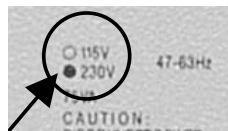
Abb. 8 Markierung der werkseitig eingestellten Betriebsspannung
