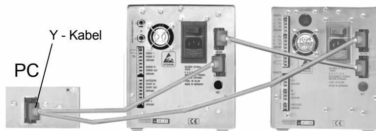
Abb. 25 Netzwerk von verschiedenen Geräten im KNAUER Netz
